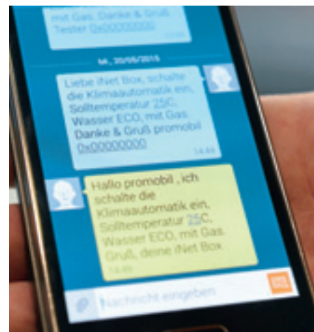
Im GSM-Modus schickt das Smartphone seine Befehle per SMS an die Steuereinheit.
