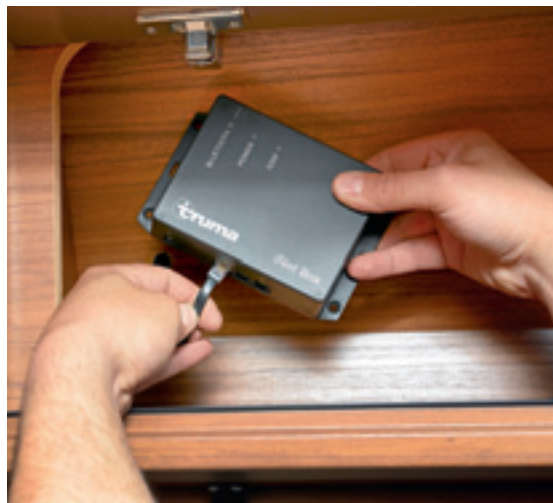
Die iNet-Box selbst empfängt die Befehle per Bluetooth oder SMS und gibt sie weiter.
