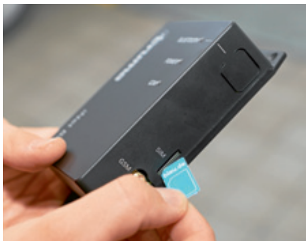
Die SIM-Karte ist für die Fernsteuerung aus großer Distanz nötig. Direkt am Mobil wird Bluetooth genutzt.
