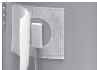
Afb. 4: Montage van de temperatuurvoeler
