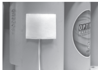
Afb. 4: Montage van de temperatuurvoeler
